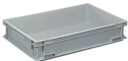
NB 24 V4 Boden geschlossen verstärkt Außenmaße 600 x 400/115 Seitenwände geschlossen Innenmaße 555 x 355/100 Muschelgriff
